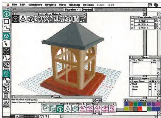
ZEICHENUTENSILIEN Alle Konstruktionswerkzeuge sind über Paletten zugänglich. Das Liniennaster in der Zeichnung kennzeichnet die aktive Arbeitsebene.
